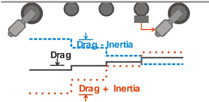
**FIGURE 2 – STRESSES ON THE OUTSIDE OF THE BEND DUE TO INPLANE ROLLER MISALIGNMENT**
